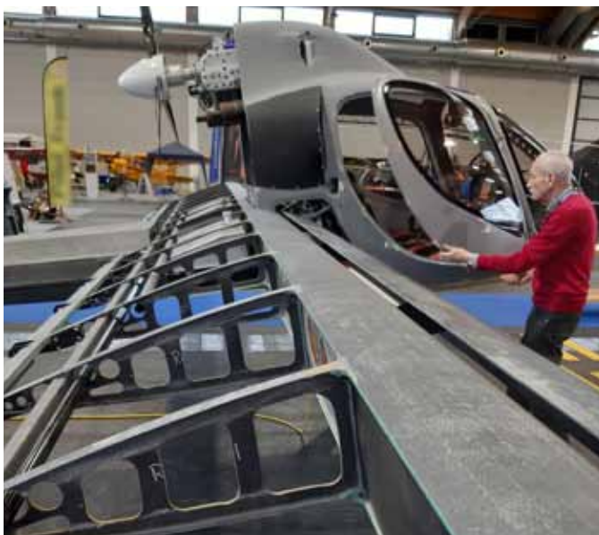
Vor dem stabilen Hauptholm befindet sich der Vorflügel. Manfred Scholz öffnet für die FliegerRevue gerade die Kabinentür.
