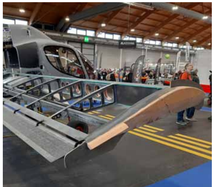
Über die ganze Spannweite gehen die Flaperons an der Flügel-Hinterkante. Durch die stabile Bauweise sind nur wenige Spanten nötig.
